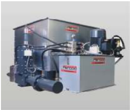
Die Baureihe RB 80 - RB 300 S Flexibel zur Brikettierung von Materialspänen
