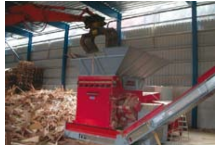
AZR 1500 munka közben – energianyerésre használt apríték előállítás
